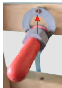
Das Saugerventil kann einfach in die Wandhalterung gesteckt werden.
