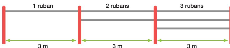
En zones ventées ou difficiles, l'espacement entre piquets ne doit pas dépasser 3 m. En zones protégées, vous pourrez espacer jusqu'à 4 m.
